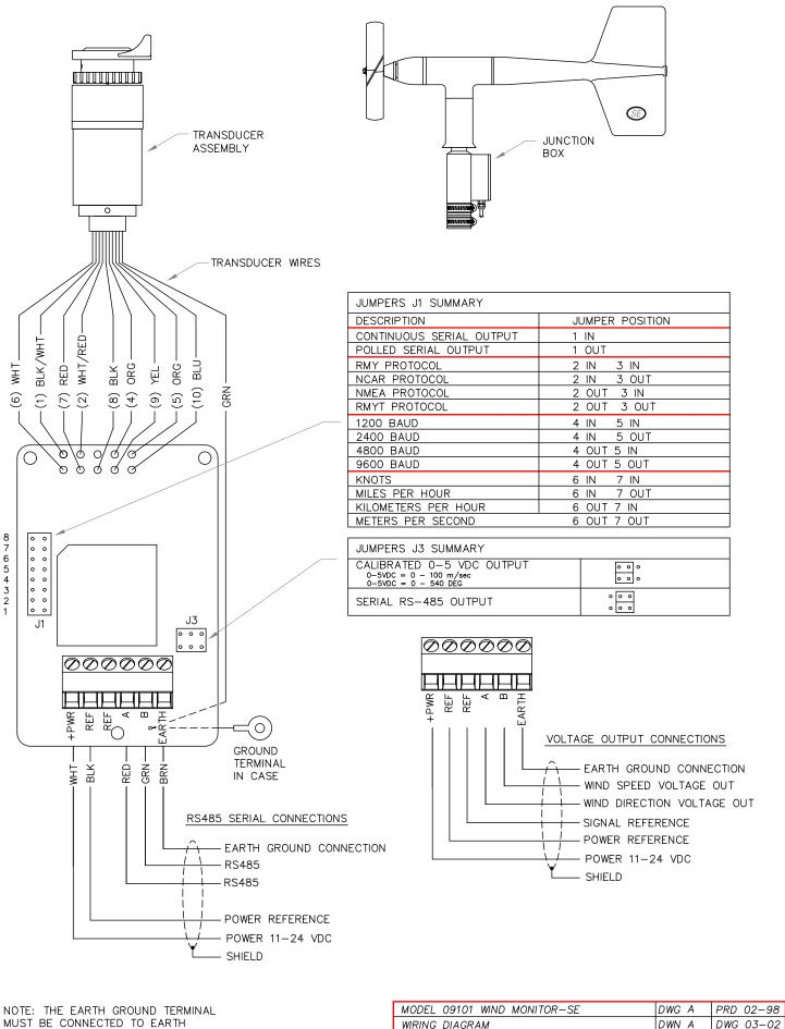
MUST BE CONNECTED TO EARTH GROUND TO PROVIDE A STATIC DISCHARGE PATH.
